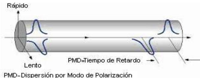
**Figura 2.8. PMD en Fibra Monomodo cuya Asimetría es Uniforme a lo largo de su Longitud [23].**
