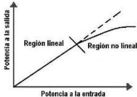
Figura 2.9. Efectos No lineales a altos Niveles de Potencia [2].
