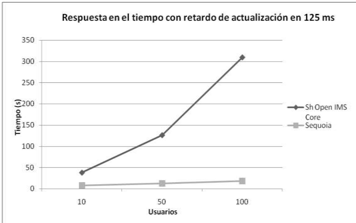
Figura 47. Comparación de la respuesta en el tiempo con un retardo de actualización de 125 ms
