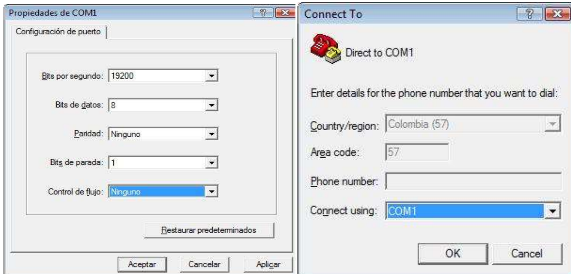
Figura 30 Configuración puerto hyperterminal
