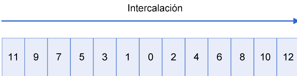
Figura 19. Segmentos de Datos intercalados [23]
