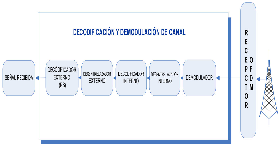
Figura 16. Diagrama en Bloques del Receptor DVB-T
