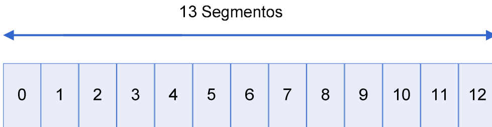
Figura 18. Segmentos de Datos en ISDB-T [23]
