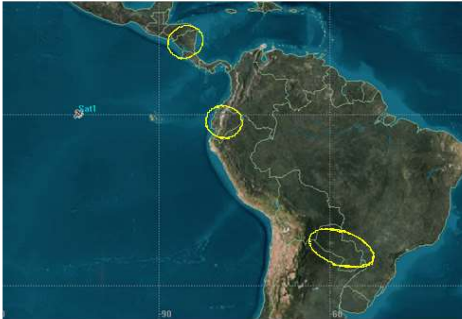
Figura 15. Huellas proporcionadas por un arreglo de 140x140 antenas.
