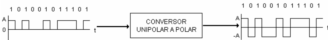
Figura 2.4. Conversión de señalización unipolar a polar.
