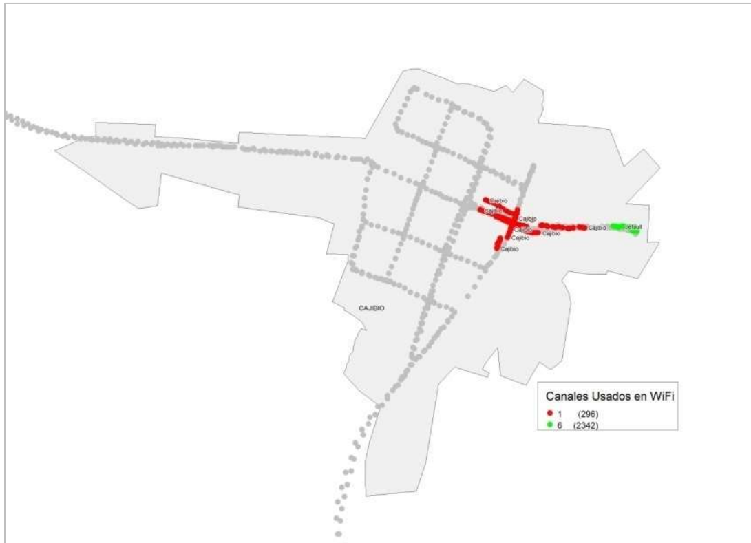
Figura 2-36 Canales Usados en WiFi Cajibío
