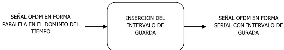
**Figura 2.30. Estructura interna del bloque inserción del intervalo de guarda.**
