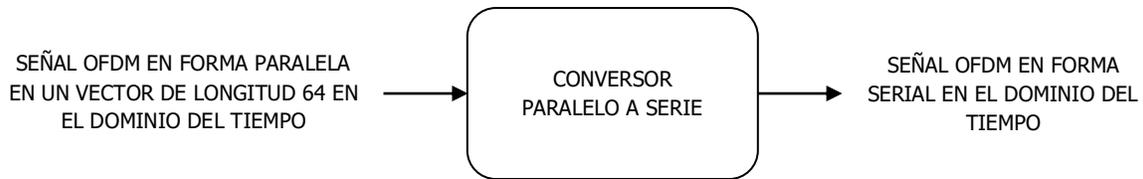
**Figura 2.29. Estructura interna del bloque conversor paralelo a serie.**
