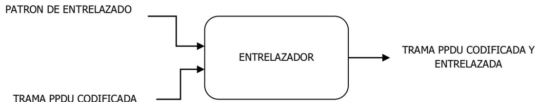
**Figura 2.24. Estructura interna del bloque entrelazador.**
