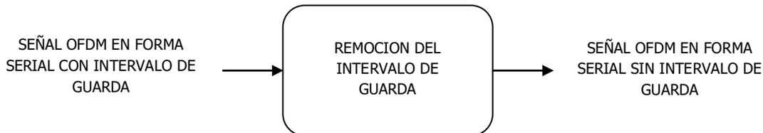
**Figura 2.33. Estructura interna del bloque remoción del intervalo de guarda.**
