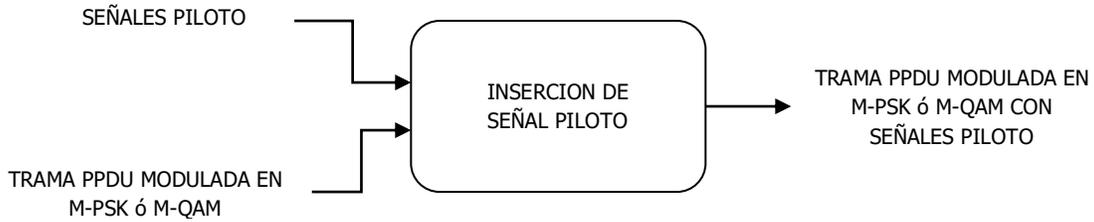
**Figura 2.26. Estructura interna del bloque inserción de la señal piloto.**
