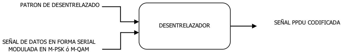
**Figura 2.39. Estructura interna del bloque desentrelazador.**
