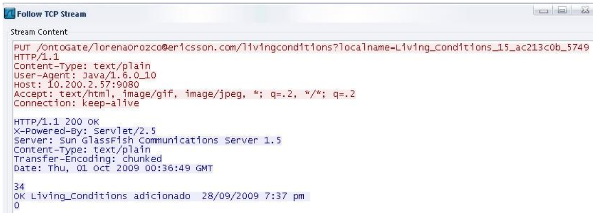
Figura 47 Flujo TCP para la adición de una propiedad.
