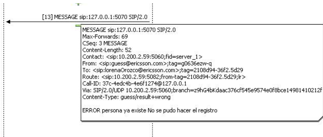
Figura 42 Respuesta a una solicitud de creación de una persona existente.
