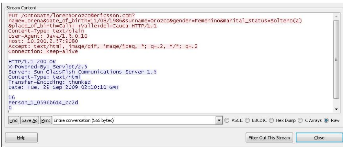
Figura 39 Flujo TCP entre el dominio IMS y el SGPU.
