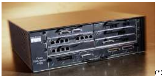
Figura 15. Enrutador Cisco 7200vxr
