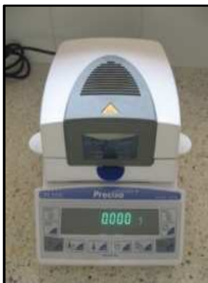
Figura 7. Balanza de humedad utilizada para la obtención del contenido de humedad de las semillas
