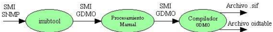
Figura #29 Proceso General de Conversión de MIBs SNMP a GDMO
