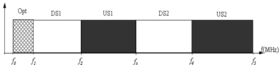
Figura 1.13 Localización de las bandas de frecuencia VDSL
