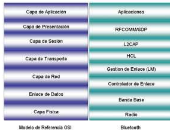
Figura A.2 Comparación entre el stack de protocolos de Bluetooth y el Modelo de Referencia OSI
