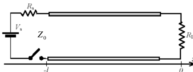
Figura 1. Línea sin pérdidas conectada a una batería
