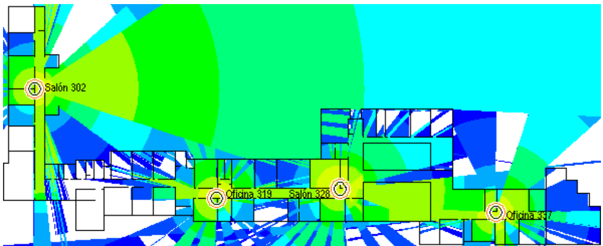
Figura 85. Tercer piso máxima velocidad de datos.
