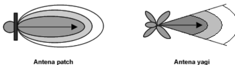
Figura 45. Patrón de radiación de una antena direccional de baja ganancia.
