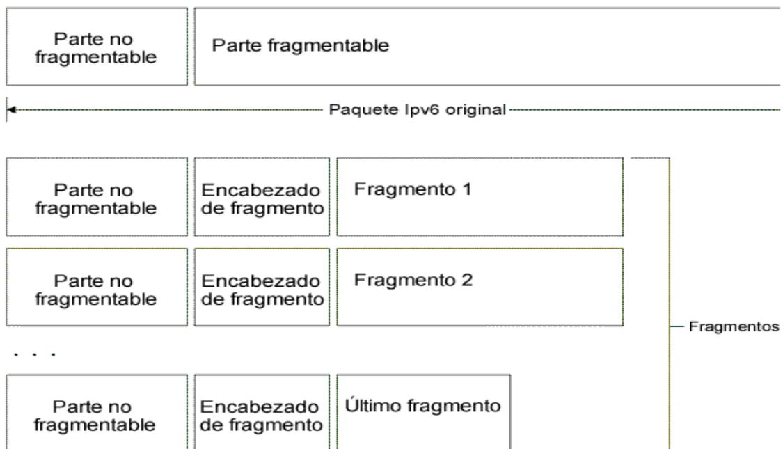
Figura A. 16. Proceso de fragmentación de IPv6
