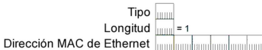
**Figura A. 33. Formato de las opciones Source y Target Link-Layer Address (Dirección de nivel de enlace de origen y destino) para Ethernet**
