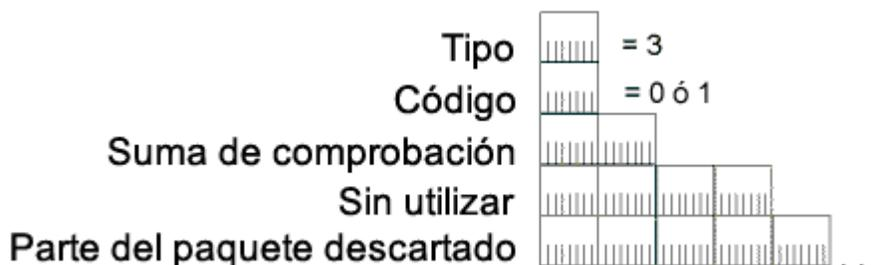
Figura A. 22. Mensaje ICMPv6 Time Exceeded (Fin de tiempo de espera)
