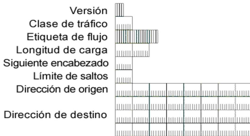
Figura A. 10. Encabezado de IPv6
