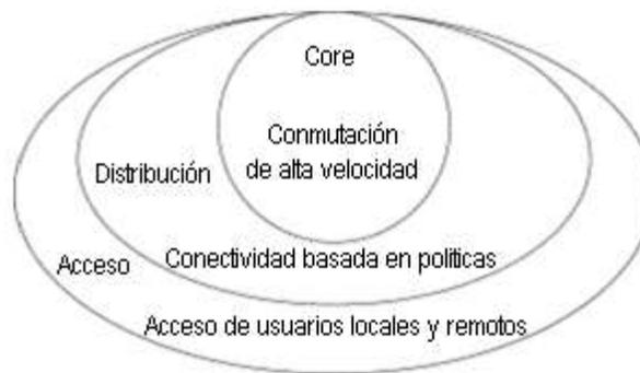
Figura 5. 1. Modelo de Diseño de red jerarquico
