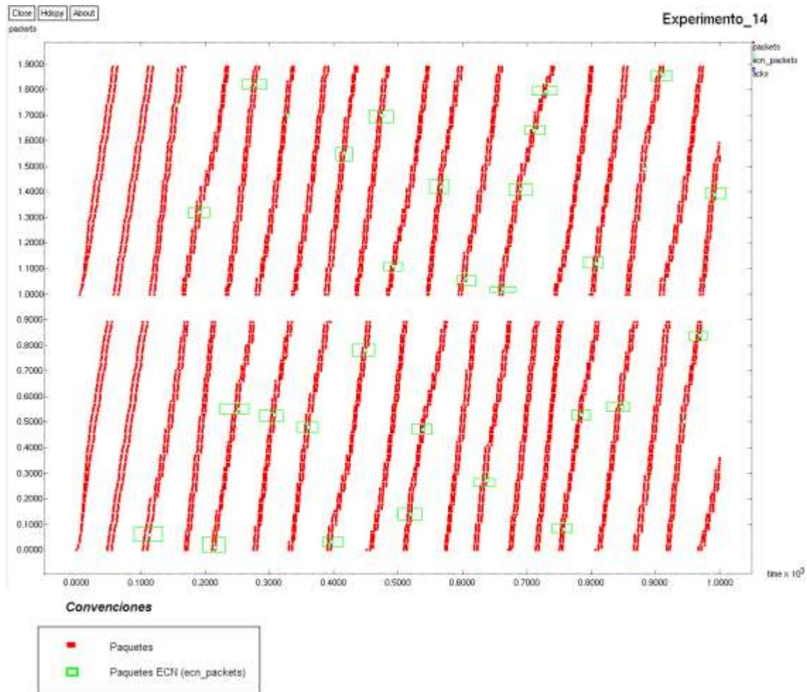
Figura 4. 10. Vista del comportamiento de los paquetes de la transmisión del tráfico FTP entre dos nodos, utilizando el método de gestión de cola RED (*Random Early Detection*) en el receptor (gateway WAP)
