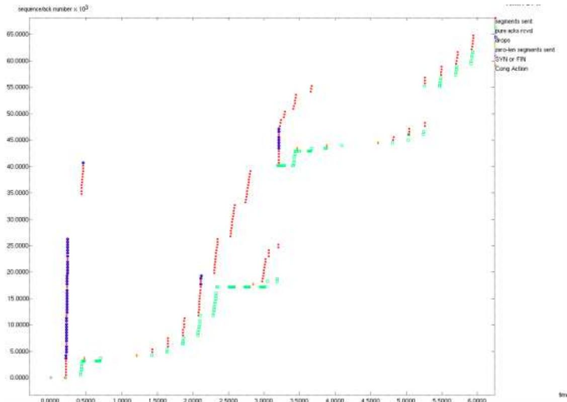
Figura 4. 4. Conexión FTP/TCP FULL con ventana inicial de 64 segmentos
