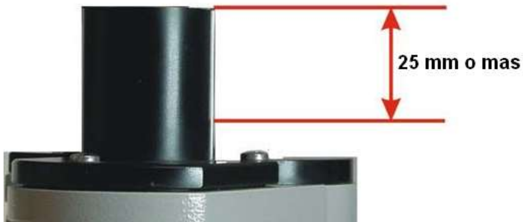
Figura 14. Medición del tubo ocular
