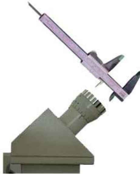
Figura 13. Medición del diámetro interior del tubo ocular
