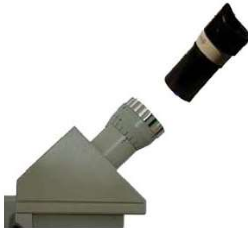
Figura 12. Extracción del ocular de un microscopio
