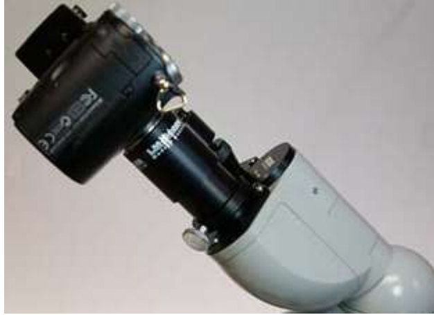
Figura 16. Fijación de la cámara al adaptador digital LM.
