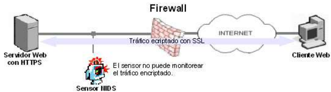
Figura 5.3. El sensor no puede vigilar tráfico encriptado.
