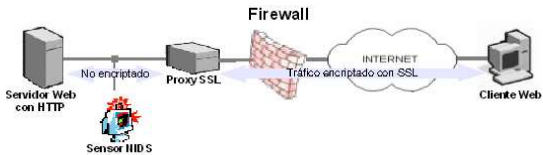
Figura 5.4. Con esta configuración el tráfico sí puede ser vigilado.
