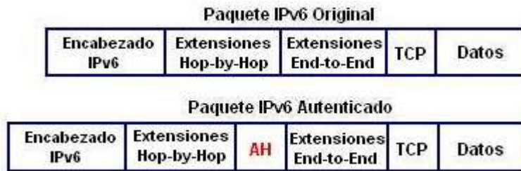
Figura 3.10 Trama IPv6 con AH en Modo Transporte
