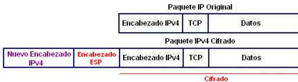
Figura 3.17 Trama IPv4 con ESP en Modo Túnel
