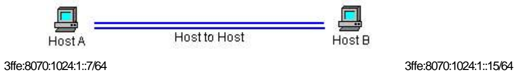
Figura 5.2 Escenario de Prueba Modo Transporte con direcciones IPv6
