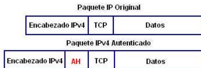
Figura 3.9 Trama IPv4 con AH en Modo Transporte
