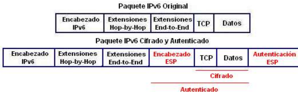
Figura 3.14 Trama IPv6 con ESP en Modo Transporte
