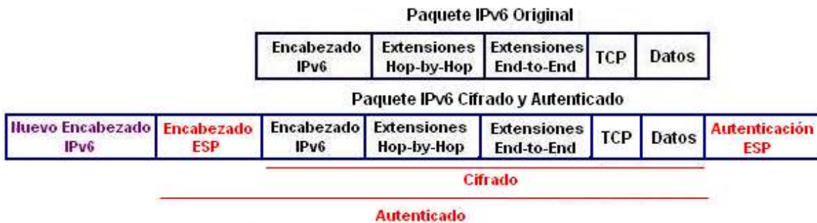
Figura 3.16 Trama IPv6 con ESP en modo Túnel
