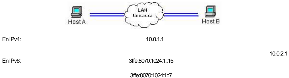
Figura 5.3 Escenario de Prueba Modo Transporte Host to Host utilizando archivos de Configuración
