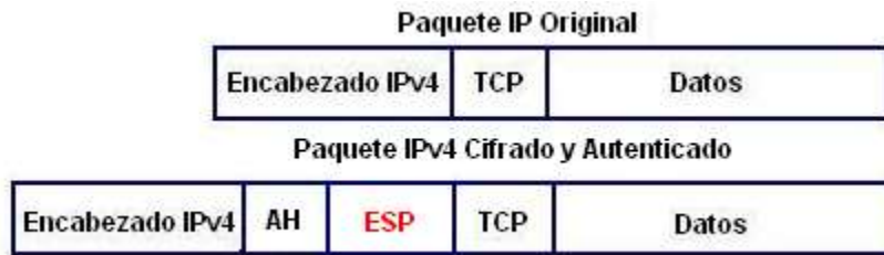
Figura 3.15 Trama IPv4 con AH y ESP en modo Transporte
