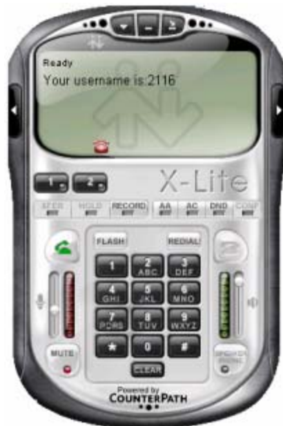
Figura B7. Registro exitoso con Asterisk después de la configuración del softphone X-lite
