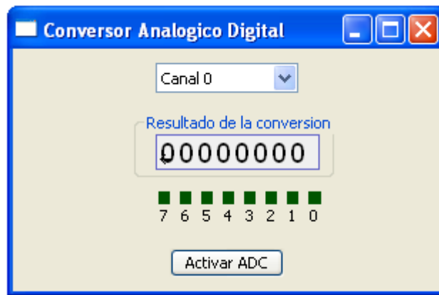
Figura B.2 Interfaz Convertor Analógico Digital
