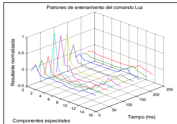
Figura 4.5. Patrones de entrenamiento de la pronunciación del comando "Luz". Las gráficas tienen un espaciamiento entre sí de 23,2 ms.
