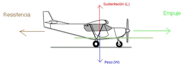
Figura 2-1. Fuerzas aerodinámicas sobre una aeronave en vuelo.
