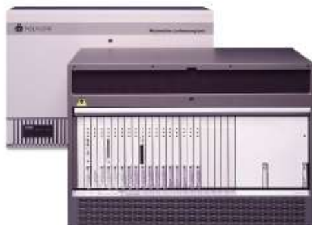
Figura 3.16 Unidad de Control Multipunto
