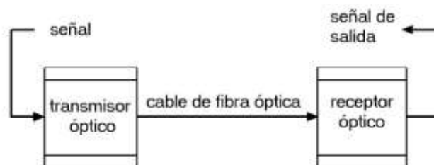
Figura 2.3. Principio de funcionamiento de la transmisión sobre fibra óptica
