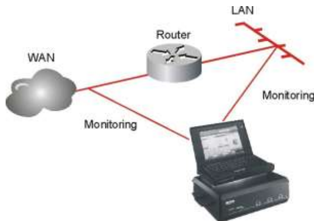
Figura 1. Configuración de prueba para medición de retardo y pérdidas en un dispositivo.
