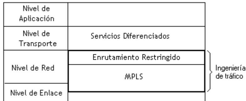
**Figura 4.11.** Posición Relativa de los Componentes de la Estructura QoS.
