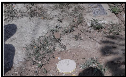
Ilustración 80 Ubicación del mojón para control topográfico Fuente: Propia
