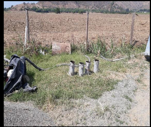
Ilustración 40 Cilindros para tomar las muestras para el ensayo de la resistencia del concreto Fuente: Propia
