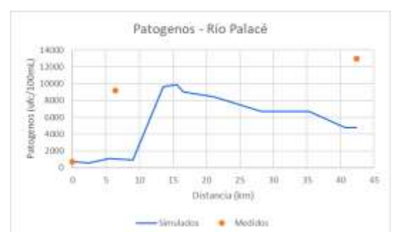
Figura 32. Curva de patógenos de la validación del modelo.
