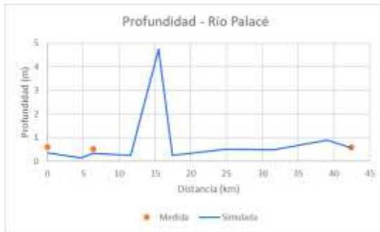
Figura 27. Curva de profundidad de la validación del modelo.
