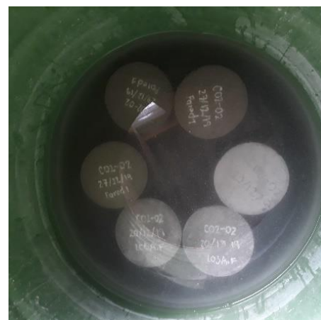
Ilustración 78. Almacenamiento en obra de muestras de ensayo.
