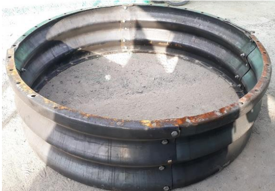
Ilustración 30. Anillo unido antes de la fijación.
