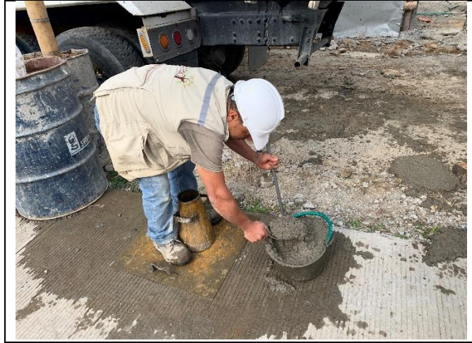
Ilustración 13. Llenado de cono para prueba del SLUMP Fuente: Propia
