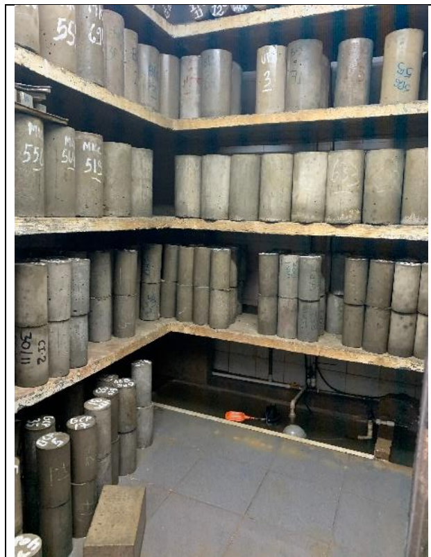
Ilustración 31. Cuarto húmedo para el almacenamiento de cilindros en concreto Fuente: Propia
