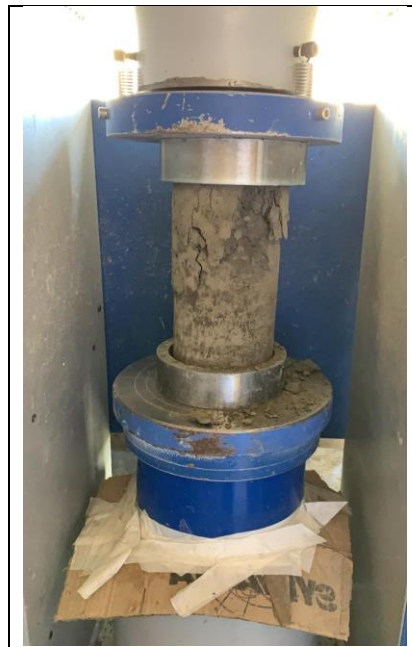
Ilustración 23. Espécimen de concreto fallado Fuente: Propia
