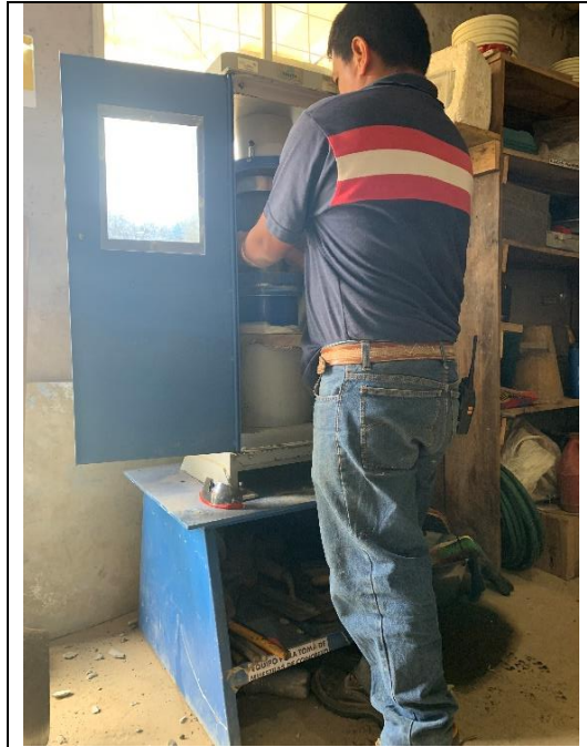
Ilustración 22. Cilindro puesto en la prensa para ser ensayado Fuente: Propia
