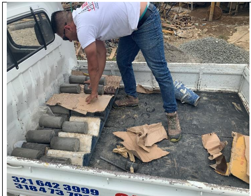
Ilustración 30. Acomodación y transporte de cilindros de concreto Fuente: Propia
