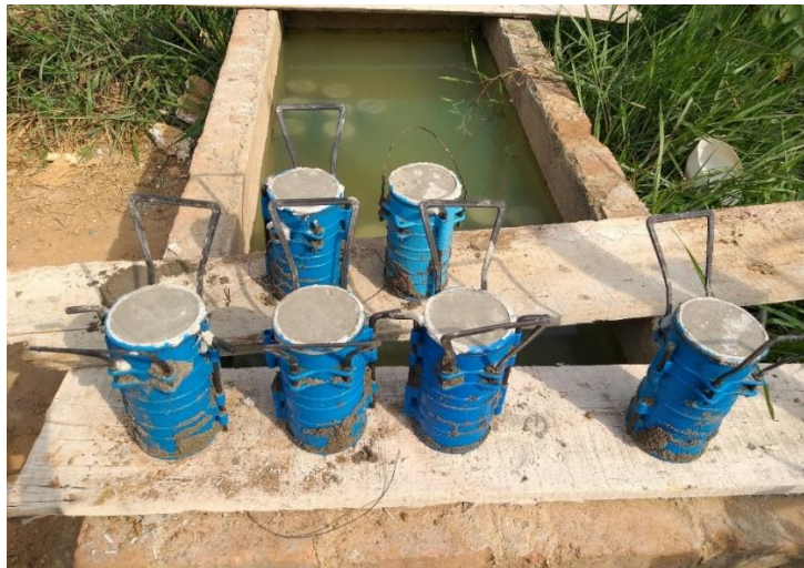
Ilustración 14: Cilindros de concreto para resistencia a la compresión. Fuente propia.
