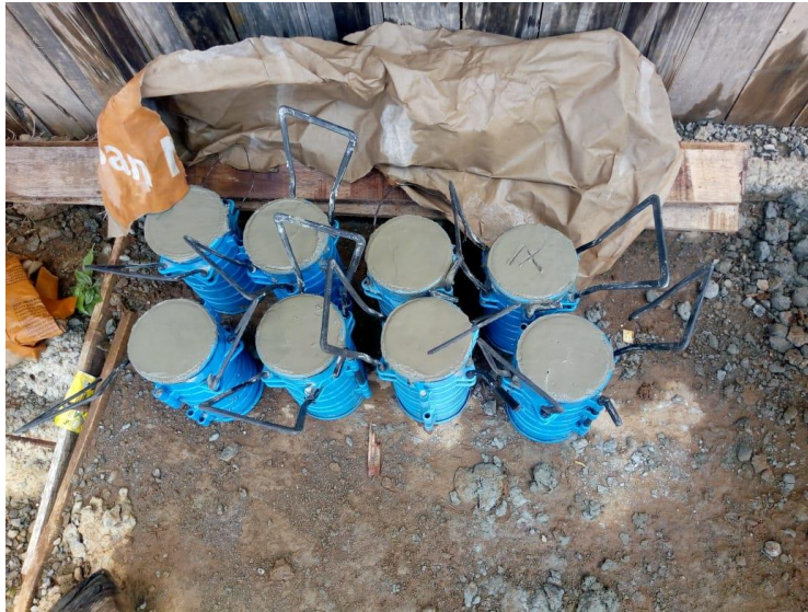
Ilustración 13: Protección de los cilindros para evitar pérdida de humedad. Fuente propia.
