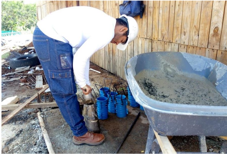
Ilustración 10: Elaboración prueba de asentamiento (Slump). Fuente propia.
