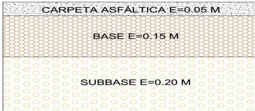
Ilustración 14. Diseño de Estructura Pavimento
