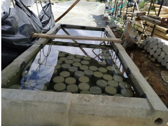
Figura 3 Tanque de curado de cilindros y zona de mezcla de concreto
