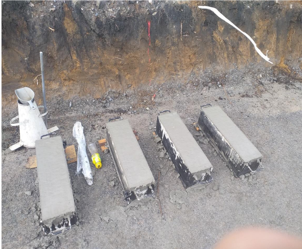
Imagen 34. Vigas de muestra para el ensayo de flexo-tracción.
