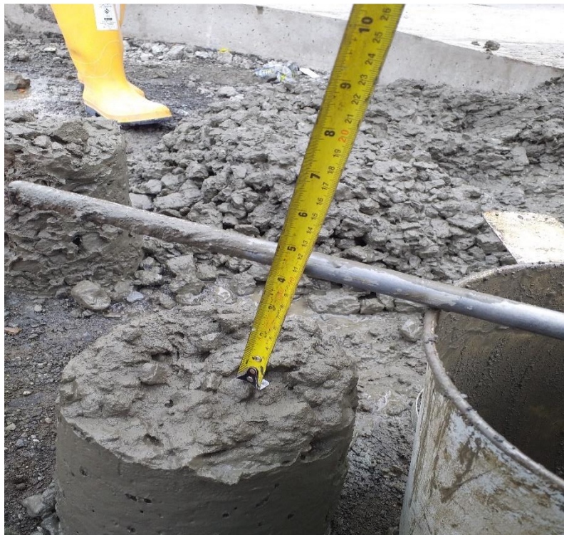
Imagen 36. Resultado del ensayo de asentamiento en pulgadas.
