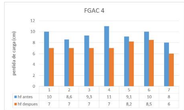
Figura 11. Pérdida de carga antes y después de lavado, FGAC 4.
