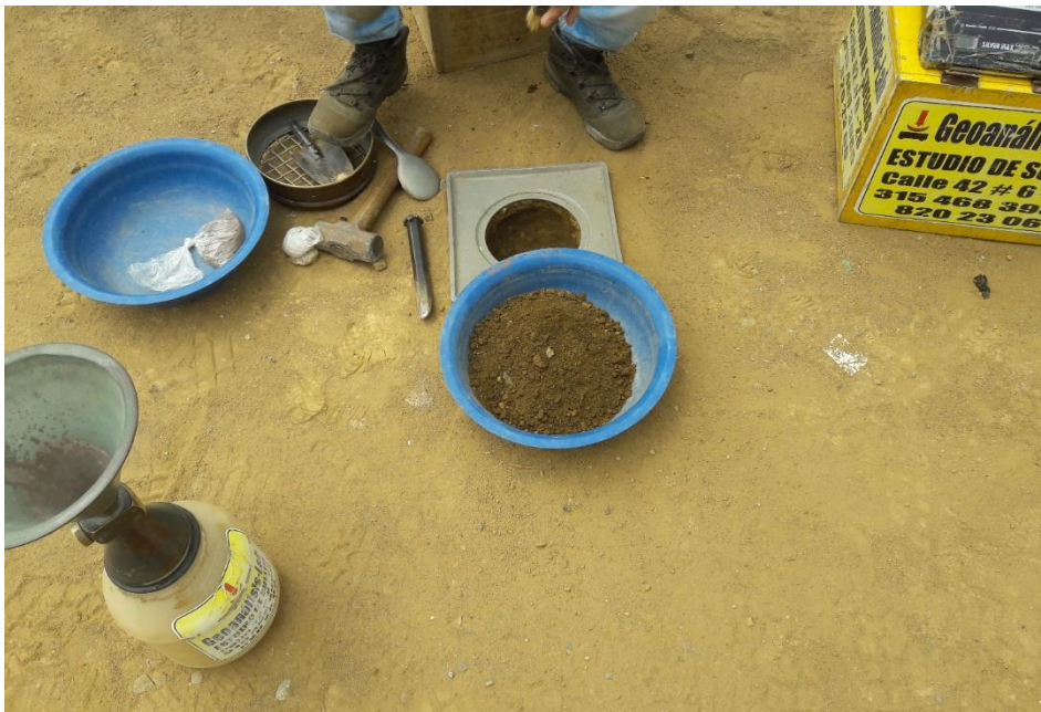
Ilustración 11 Toma de muestra para prueba de densidad (método del cono y la arena)
