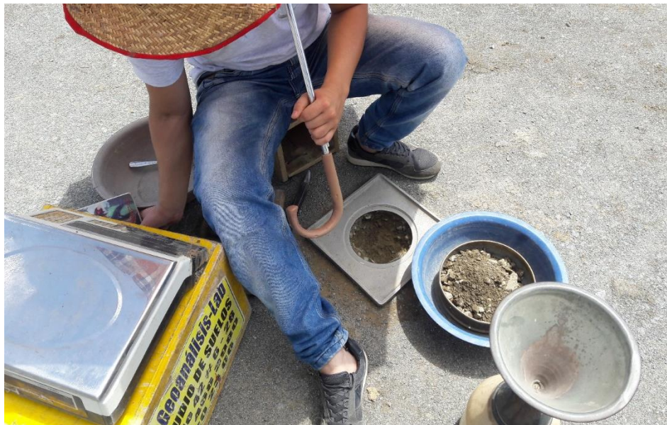
Ilustración 13 Toma de muestra para prueba de densidad de la subbase (método del cono y la arena)
