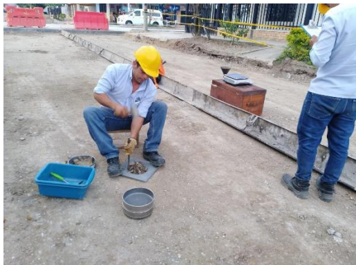
Fotografía 18. Toma de muestras para chequear densidades del terreno.
