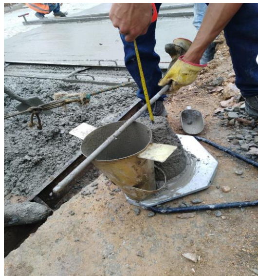
Fotografía 9. Resultado de slump en campo en este caso particular 3.5” en tramo 2 calzada izquierda carril izquierdo k0+416.
