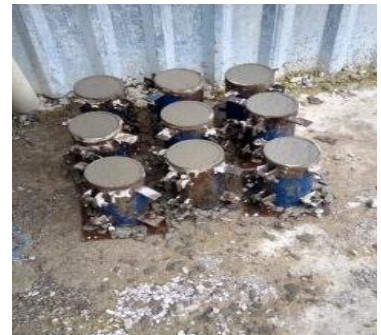
Figura 31. Muestra en cilindros
