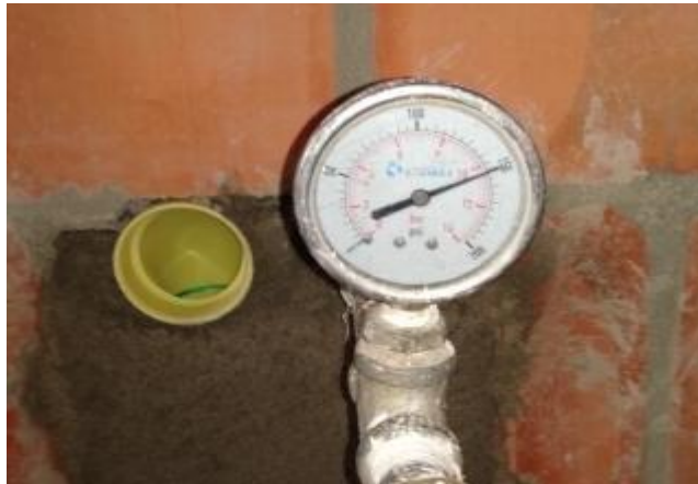
Figura 100. presión hidrostática en el manómetro
