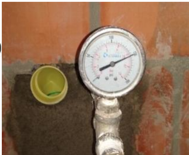
Figura 51 y 52 bomba manual de embolo y prueba de presión tomada en uno de los apartamentos Fuente: propia
