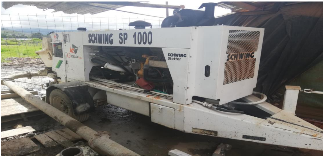
Figura 22 bomba estacionaria impulsadora de concreto swing sp 1000cc. Fuente: Propia.
