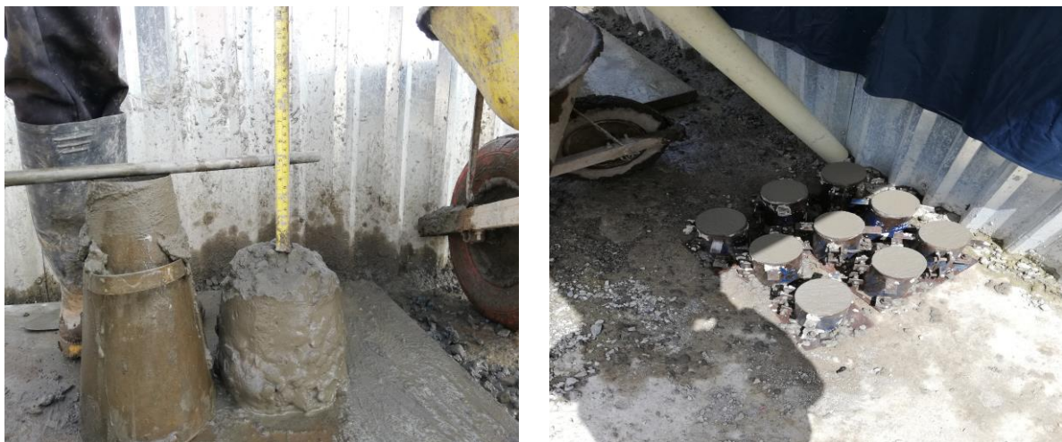
Figuras 20, y 21 Prueba de asentamiento con el “slump” y muestra de cilindros para la prueba de resistencia. Fuente: Propia.
