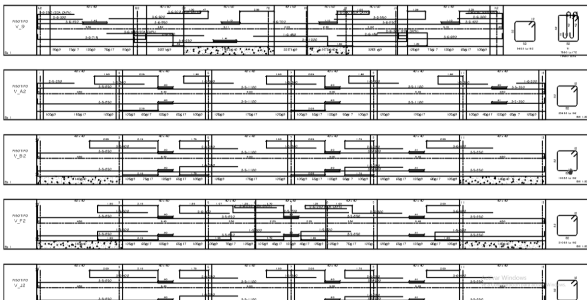
Figura 55. Plano de despiece de algunas vigas y viguetas torre A condominio Marsella. Fuente: Propia.
