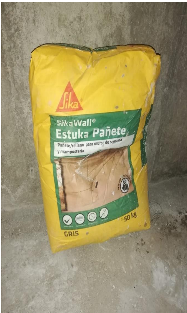
Figuras 43 y 44. Material relleno y estuco SIKA para acabados muros internos Fuente: propia
