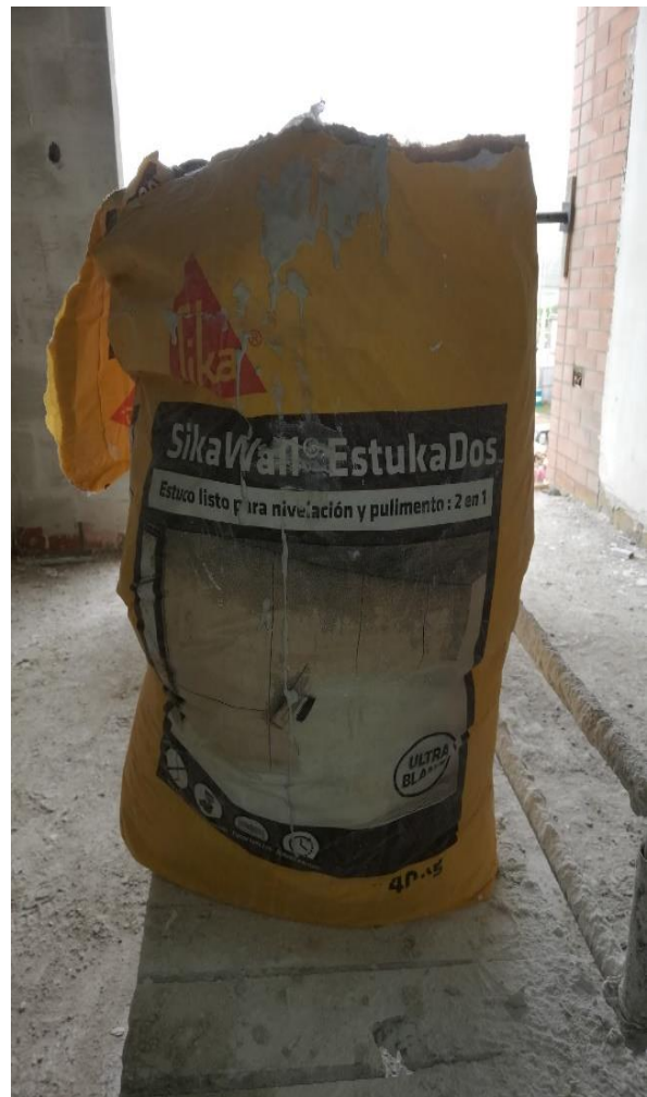
Figuras 43 y 44. Material relleno y estuco SIKA para acabados muros internos Fuente: propia
