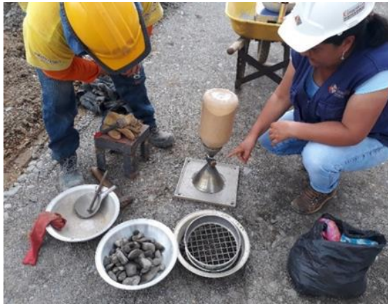
Ilustración 37. Toma de densidades con cono de arena Fuente: autor
