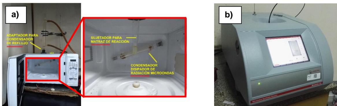
**Figura 5.** Equipos de radiación microondas. a) Equipo microondas modificado (multimodo). b) Reactor microondas (monomodo).
