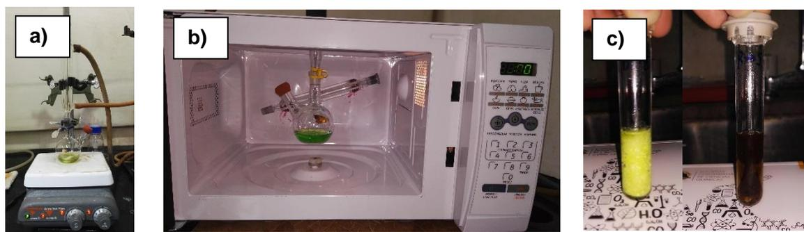
**Figura 8.** Síntesis de **6** mediante calentamiento: a) convencional. b) microondas multimodo c) microondas monomodo: antes de reacción (izquierda) y después de reacción (derecha).
