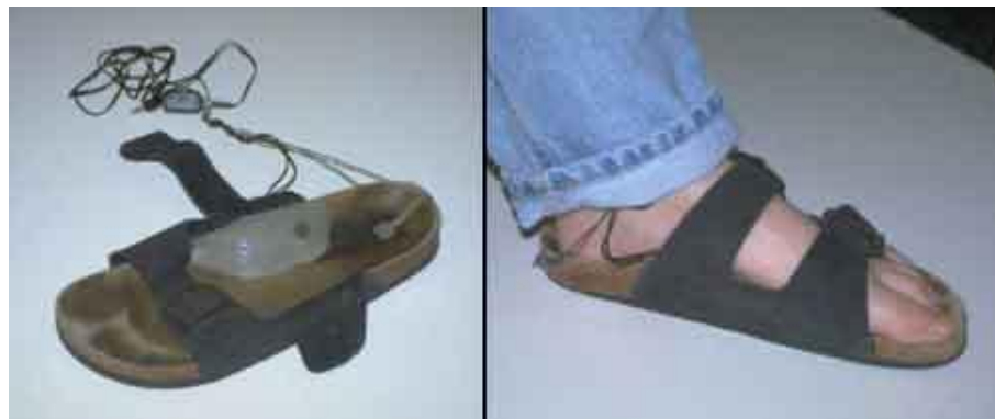
Ilustración 12. Zapato con sensor de respuesta galvánica de la piel. Tomado de [85]
