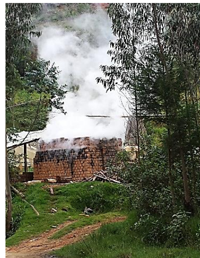
Foto 3. El horno de la ladrillera
