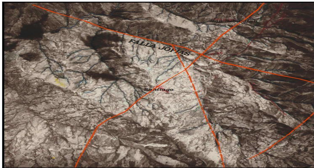
Foto 272. Fotografía aérea de la zona en donde se resalta en color rojo la Falla Jopias (Línea continua sentido E-W) y algunos lineamientos (Línea punteada).
