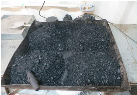
Fotografía 3. Cuarteo Mezcla Asfáltica
