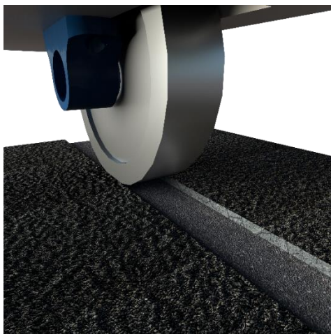
Figura 14. Deformación cuerpo de prueba
