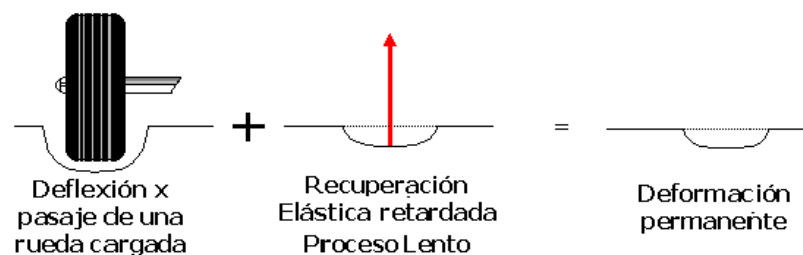
Figura 1. Deformaciones permanentes (Ahuellamiento)
