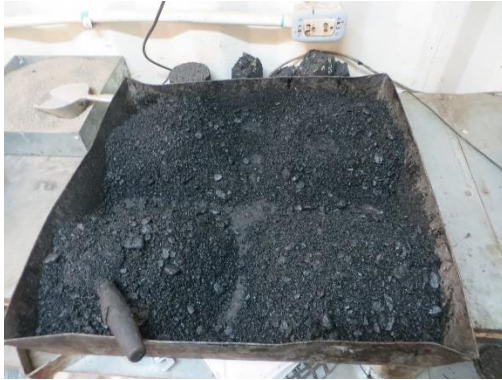
Fotografía 9. Cuarteo Mezcla Asfáltica
