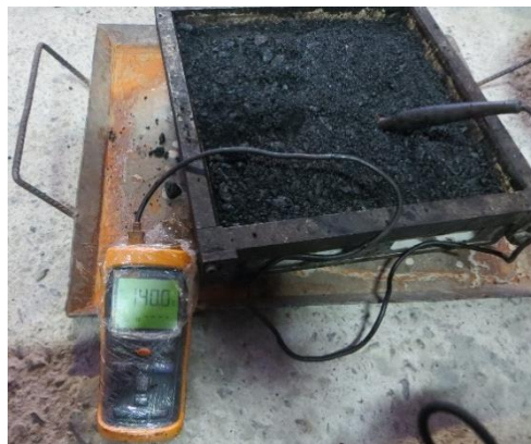
Fotografía 5. Temperatura de Compactación Mezcla Asfáltica.
