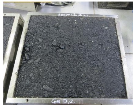
Fotografía 16. Compactación de la muestra.
