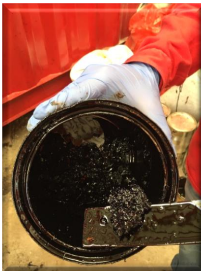
Figura 7-1 Grumos de Almidón Gelatinizado Formados Durante el Proceso de Mezclado
