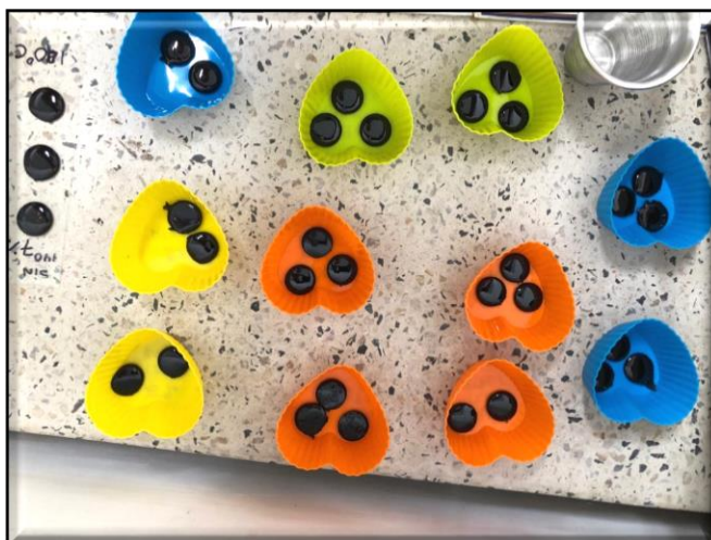
Figura 6.12 Muestras de 25 mm de diámetro y 1 mm de altura de Cemento Asfáltico modificado con Almidón de yuca para los ensayos de PG y MSCR
